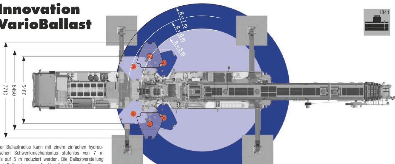
Der Ballastradius kann mit einem einfachen hydraulischen Schwenkmechanismus stufenlos von 7 m bis auf 5 m reduziert werden. Die Ballastverstellung VarioBallast ist ein großer Vorteil bei beengten Einsatzbedingungen. So entspricht zum Beispiel ein Radius von 5 m dem Wert von Mobilkränen der 200-Tonnen-Klasse.
